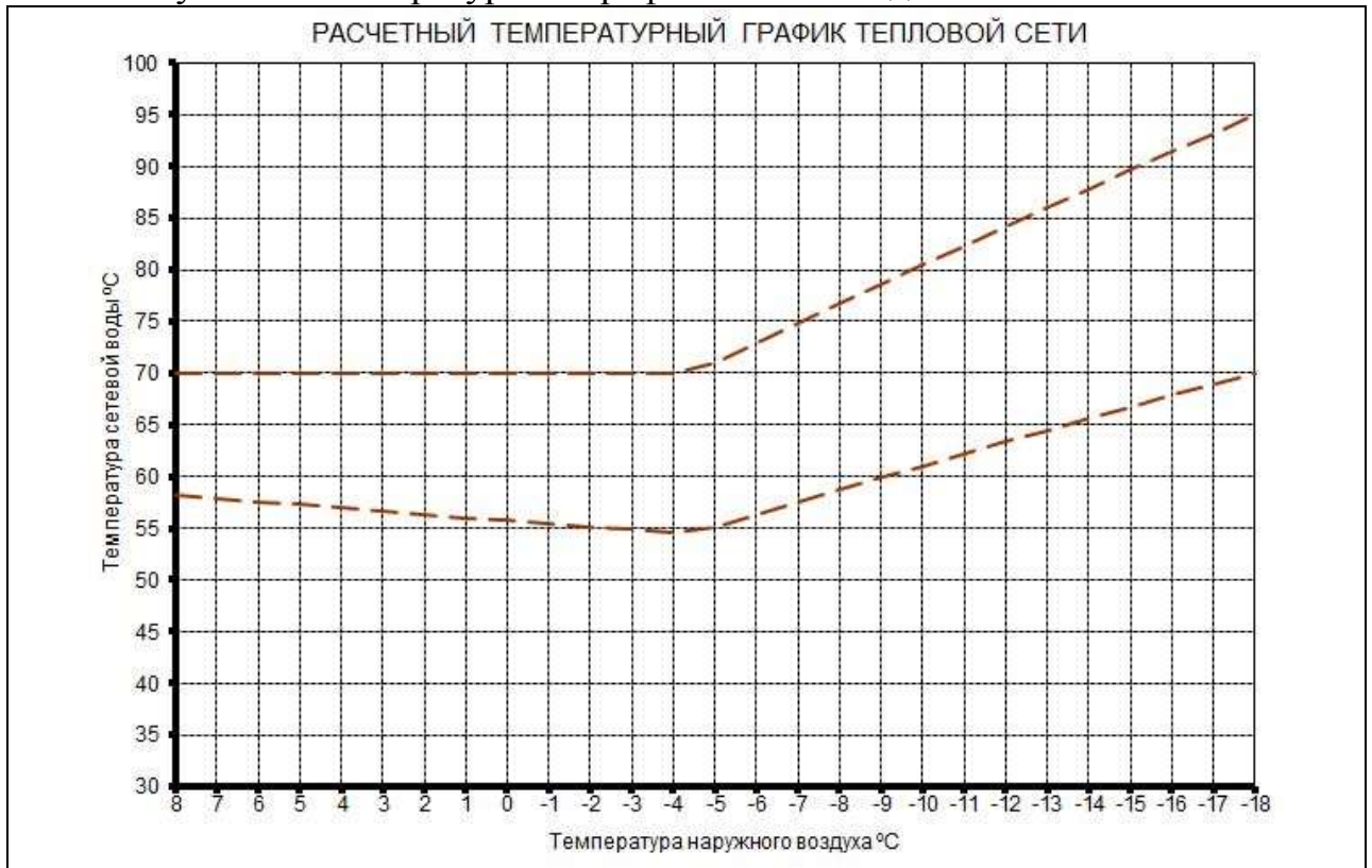
Рисунок 3. Температурный график 95 - 70 °С для отопления с ГВС.
